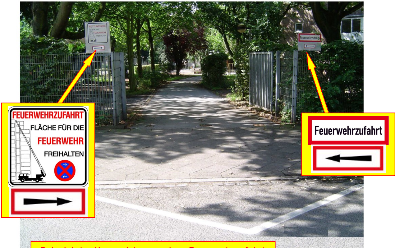
Beispiel der Kennzeichnung einer Feuerwehrezufahrt
