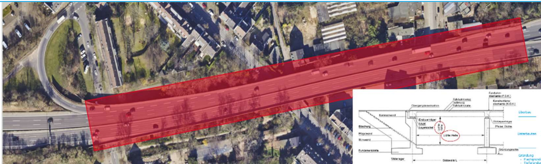
Variante 3a: Mehrere Brücken mit Dammschüttung*
