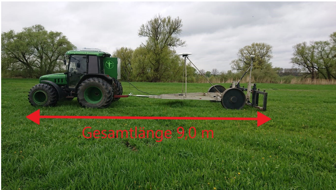
Abbildung 7 (Traktor mit Messwertanhänger, Meter breit, 9 Meter lang)
