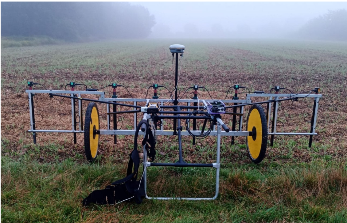
Abbildung 6 (Handwagen 8 Sonden, 3,50 Meter breit)
