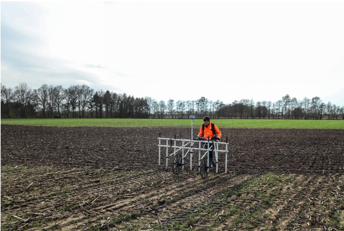
Abbildung 5 (Handwagen 9 Sonden, ca. 2,50 Meter)
